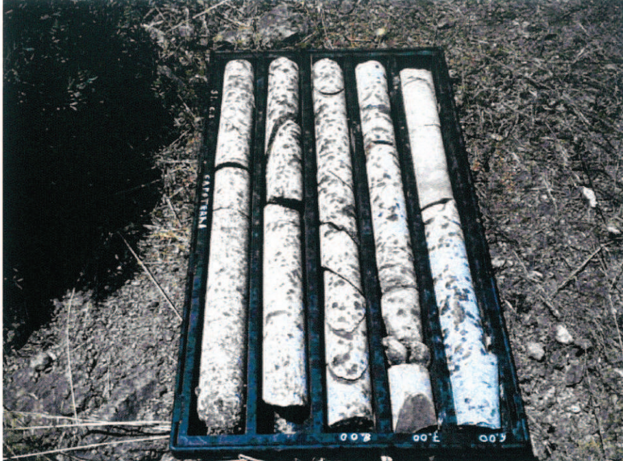
Carotaggio del sondaggio S9 (0-5m)
