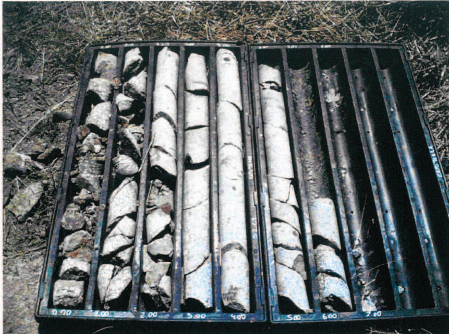
Carotaggio del sondaggio S8 (0-6m)
